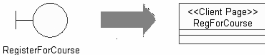
Rys. 5. Przejście od klasy analitycznej do klasy projektowej na przykładzie klasy o stereotypie Boundary
