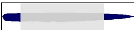
Rys. 1. Przykład wykresu postaci czasowej dźwięku waltorni, a razkreślne (440Hz). Zacieniowano stan quasi-ustalony
