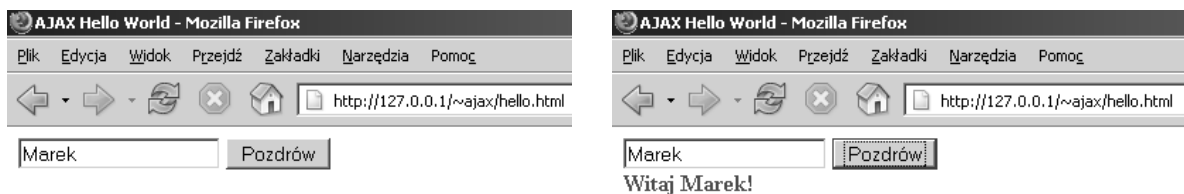
Rys. 3. Efekt działania aplikacji wysyłającej sparametryzowane żądanie do serwera
